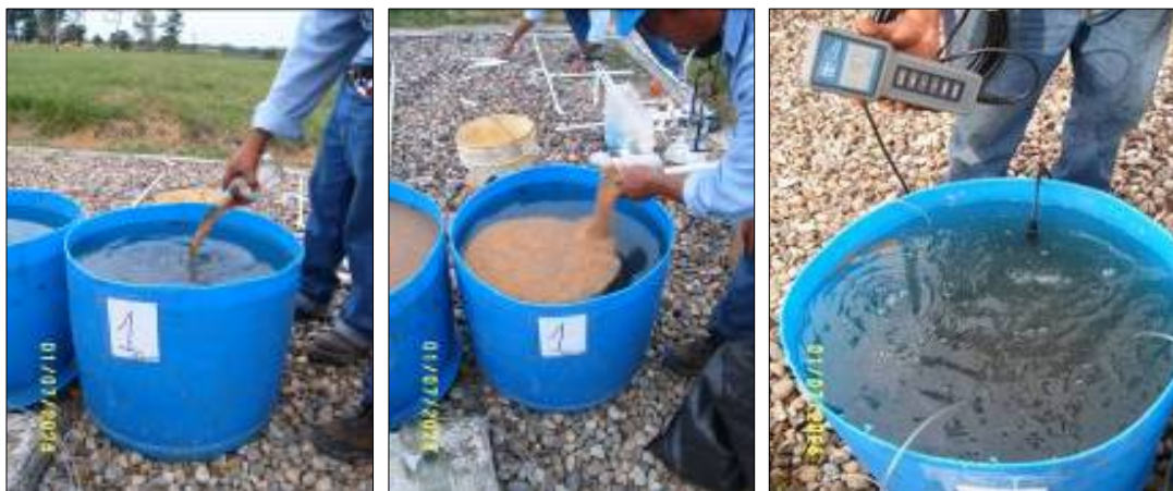
Foto 7. Escalado de Fenobiol. Se presenta la adición de nutrientes y Fenobiol y el seguimiento del crecimiento microbiano, a través de la medición continua de oxígeno disuelto y la temperatura del agua.
