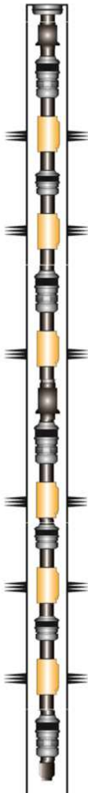
Figura 7: Sarta Selectiva corrida en un pozo en Colombia.
