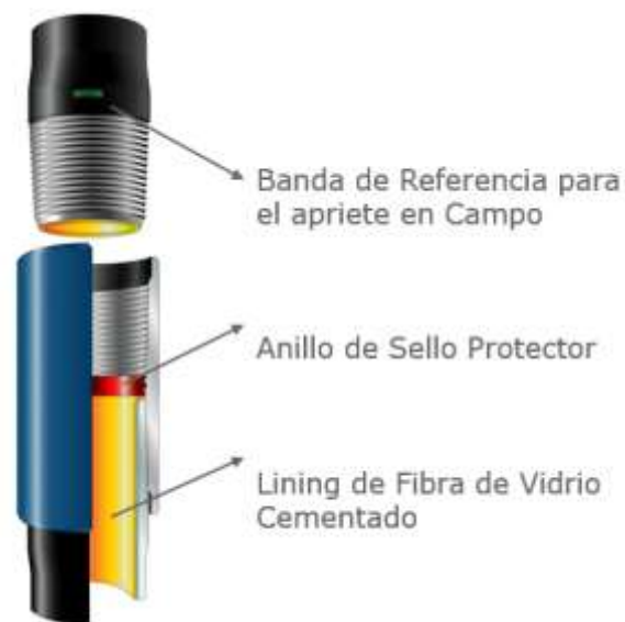
Figura 36: Recubrimiento interno GRE a tubería.
