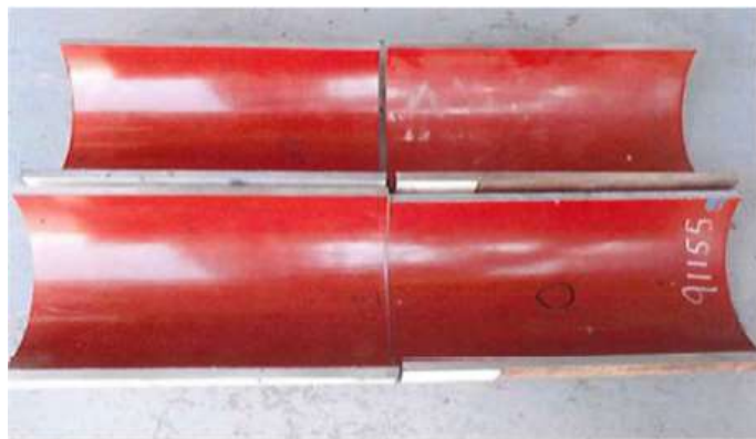
Figura 37: Recubrimiento interno con resina epoxy.
