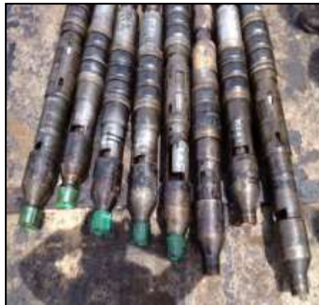
Figura 18: Inspección física en general de PACKERS.
