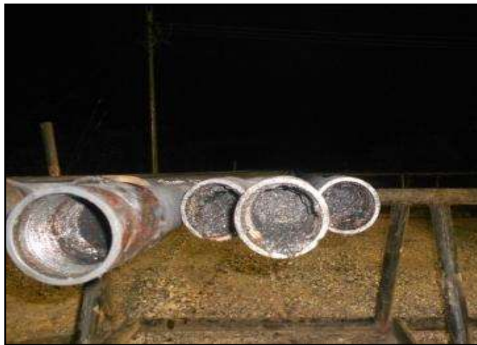
Figura 20: Accesorios BHA tapados de arena.
