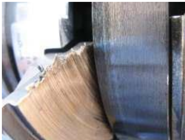
Figura 35. Desgaste total de pastilla de rodamiento de empuje axial
