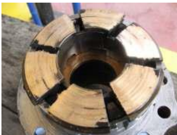
Figura 36. Evidencia desgaste sobre pastillas del sistema
