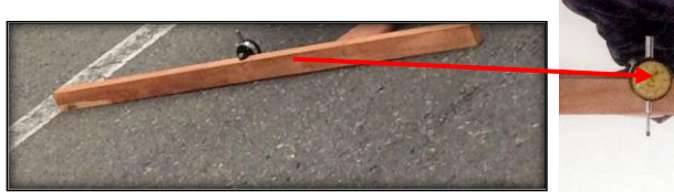
Figura 16. Ilustración de la medición del ahuellamiento.
