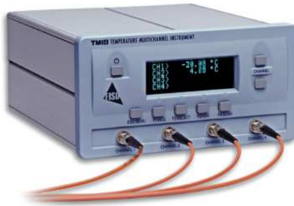
Figura 29. Sistema de acondicionamiento de señal para los sensores ópticos
