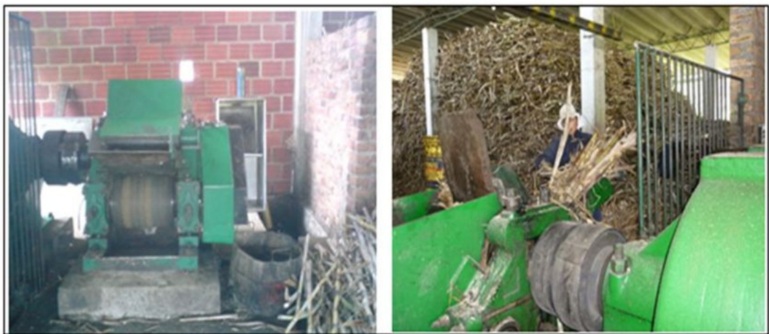
Figura 24. Molino Para extracción de jugos
