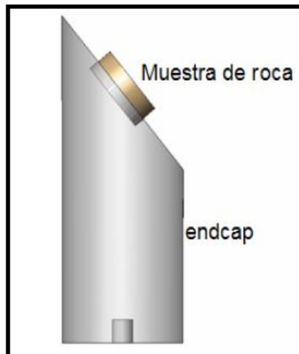
Figura 5.13. Montaje de la roca en el endcap, para el DCDI de 50°. Fuente: Mantilla H. Hernán D y Reyes T. Javier Enrique, Tesis de Grado, 2009.
