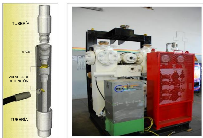
Figura 17. Equipos del subsistema para la circulación continua, Sub y Colector.
