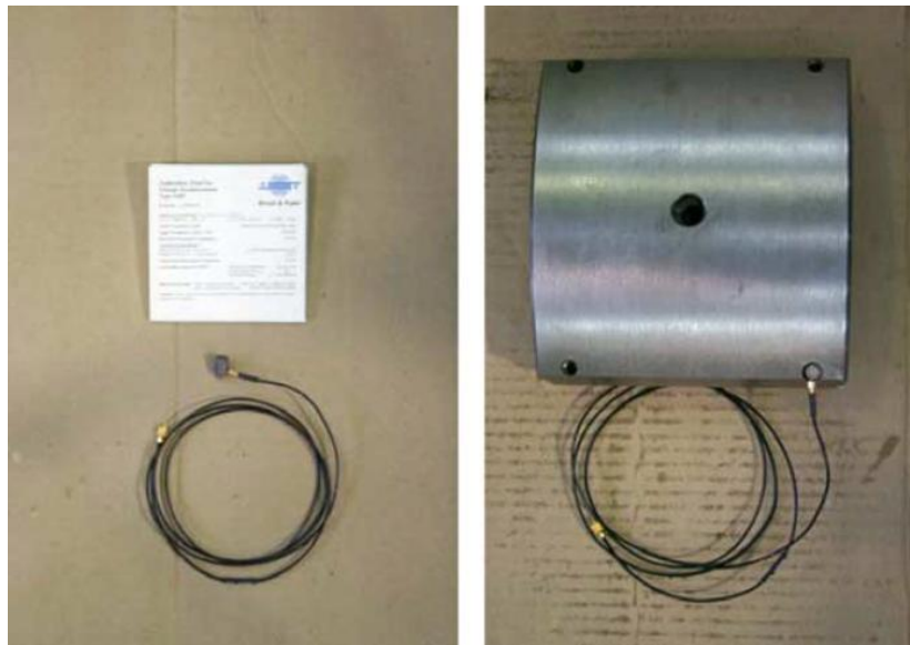
Figura 23.18: Fotografía del acelerómetro instalado en las almohadillas superiores.
