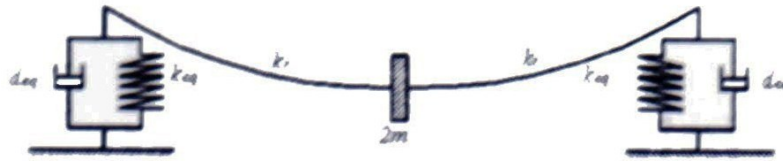
Figura 21.26: Modelo de rotor ligero y cargado centralmente soportado por dos cojinetes hidrodinámicos de aceite.
