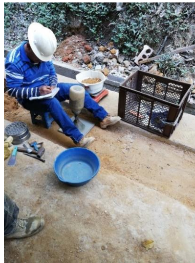
Figura 21. Masa unitaria del suelo en el terreno método del cono de arena.
