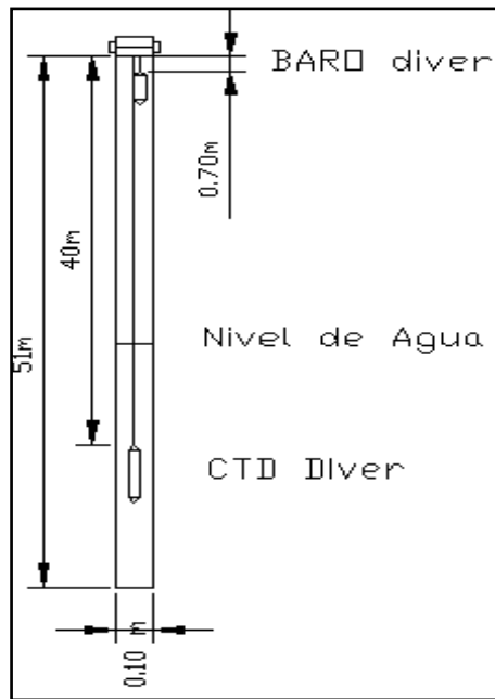
Figura 14. Disposición del Piezómetro y Equipos
