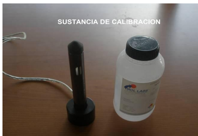
Figura 9. Sustancia Calibración CTD Diver
