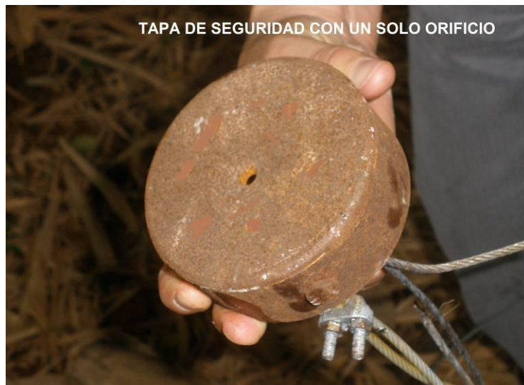
Figura 18. Tapa con un solo Orificio
