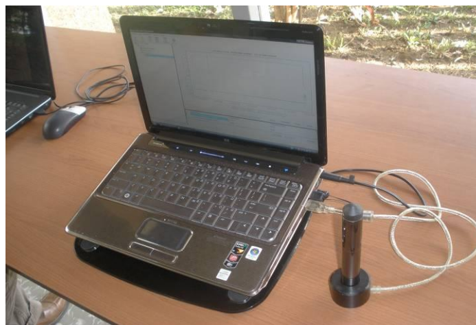
Figura 6. Conexión USB Diver Reading
