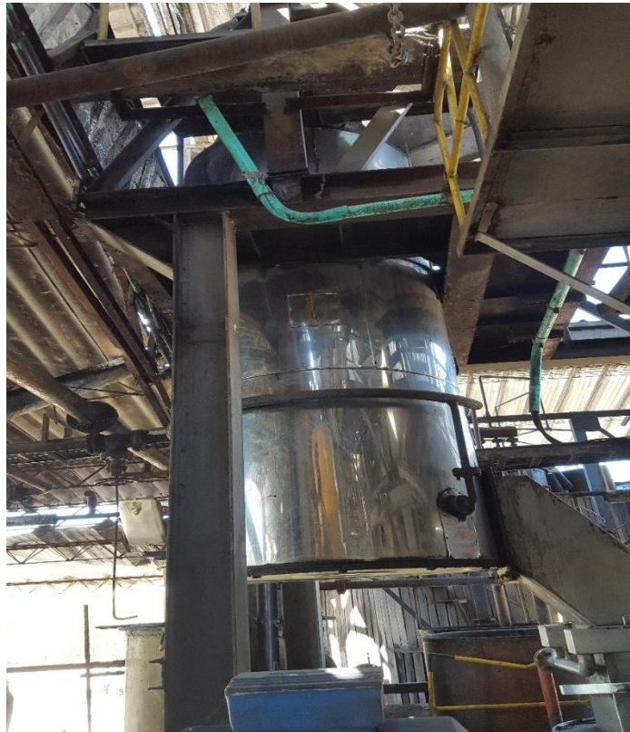
Figura 22. Digestor de frutos en PALMARIGUANÍ S.A.
