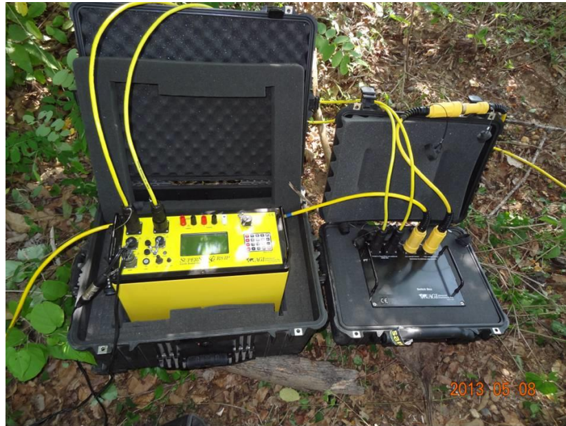
Figura 27. Equipo de resistividad SuperSting R8 IP empleado para la ejecución de las Tomografías Eléctricas 2D en el sector la Mesa del municipio de Los Santos, departamento de Santander.
