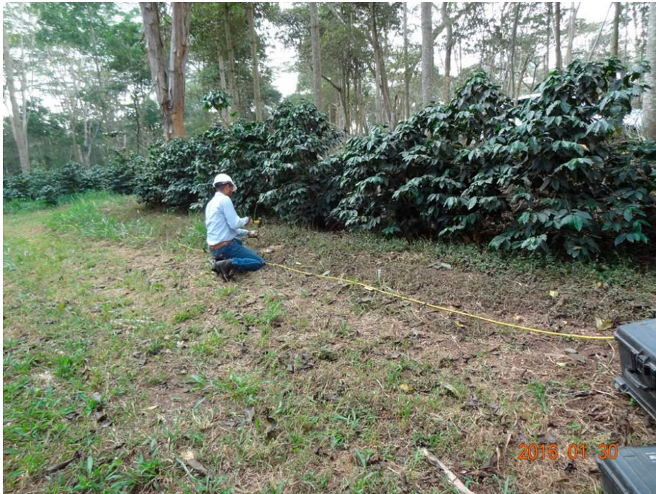
Figura 49. Instalación del multicable al electrodo para la Tomografía Eléctrica 2D T8
