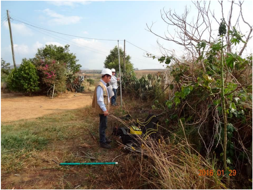
Figura 42. Centro de adquisición de datos para la Tomografía Eléctrica 2D T7.
