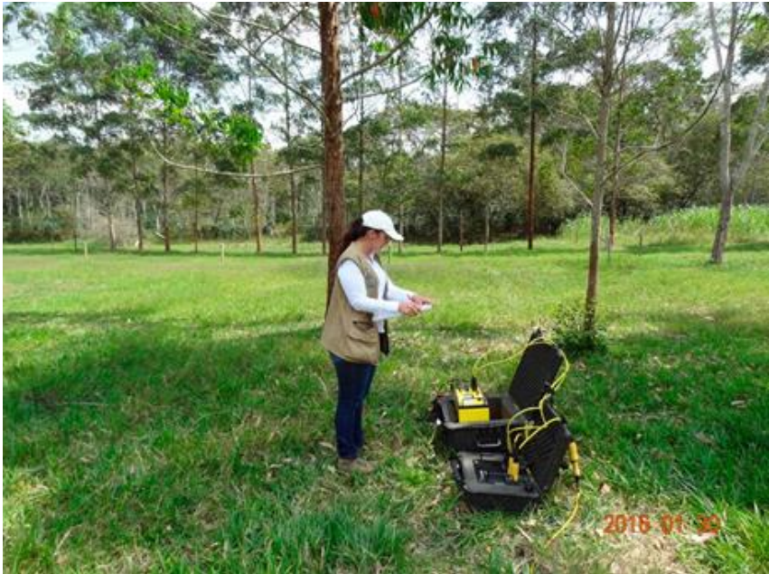
Figura 47. Centro de adquisición de datos para la Tomografía Eléctrica 2D T8.
