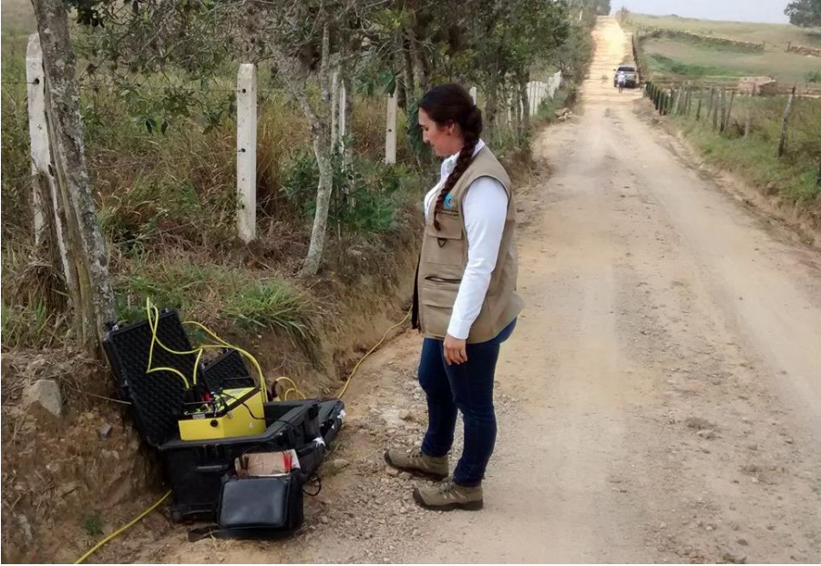
Figura 36. Centro de adquisición de datos para la Tomografía Eléctrica 2D T6.
