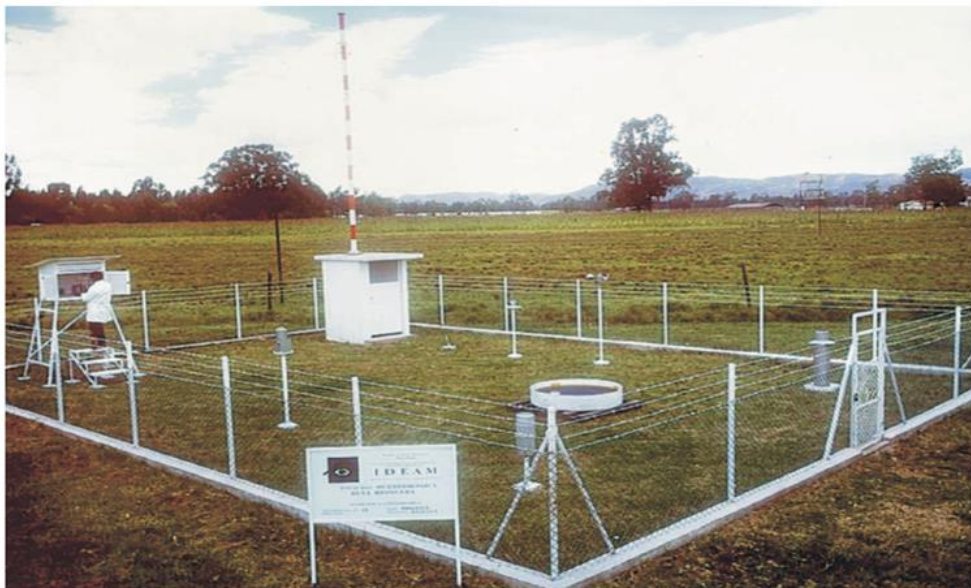
Figura 21. Emplazamiento de instrumentos en una estación meteorológica.
