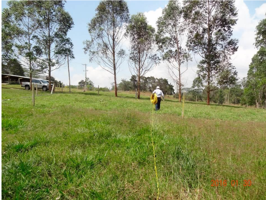
Figura 49. Instalación del multicable al electrodo para la Tomografía Eléctrica 2D T8
