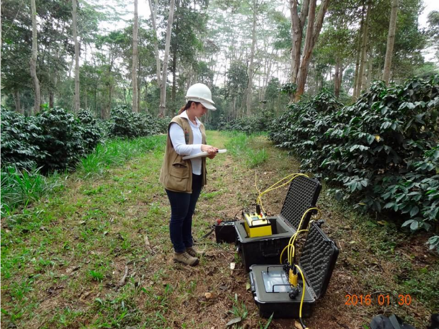
Figura 46. Centro de adquisición de datos para la Tomografía Eléctrica 2D T8.
