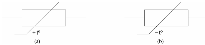
Figura 4. Representación eléctrica de un termistor.
