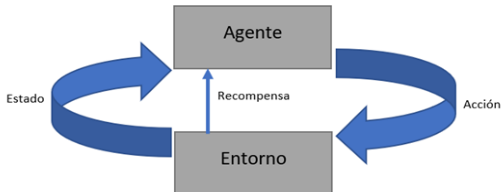
Figura 2. Estructura básica del Aprendizaje por Refuerzo.
