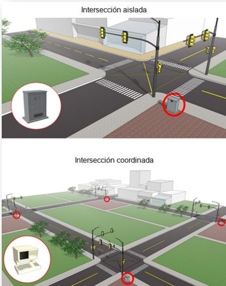
Figura 8. Ejemplo de intersección aislada y coordinada con control local y central respectivamente.
