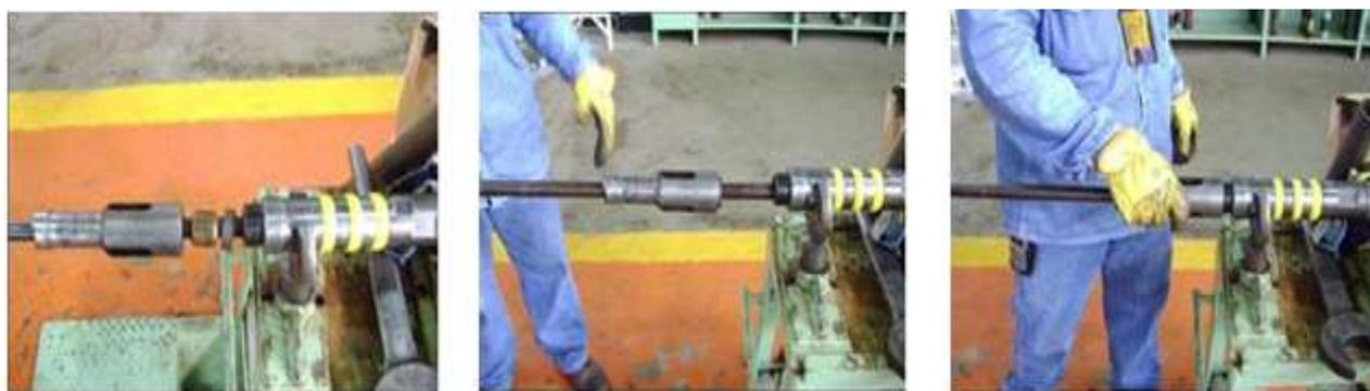
*Figura 22.* Instalación de la Bomba al Mandril de Anclaje. Fuente: Taller de bombas mecánicas de subsuelo Ecopetrol S.A
