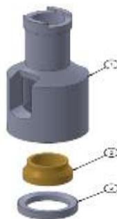
*Figura 19.* Caracterización Válvula Sand Check del Sistema de Bombeo Mecánico. Fuente: SolidWorks Programa Usado – David Duarte Peña Diseñador – 2017 –de todas las Figuras
