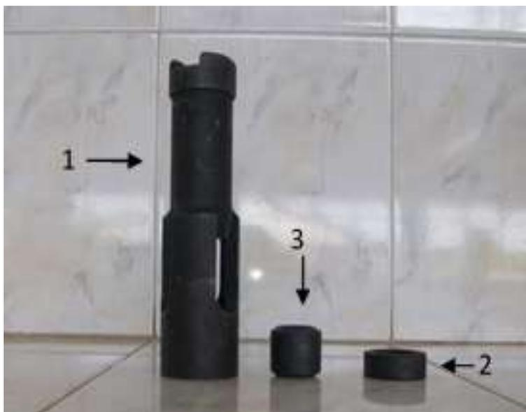
*Figura 9.* Sand Check. Fuente: Taller de Bombas Mecánicas de Subsuelo.
