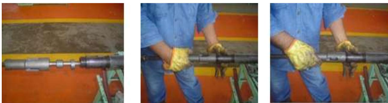
*Figura 23.* Conexión de la bomba a la C21. Fuente: Taller de bombas mecánicas de subsuelo Ecopetrol S.A
