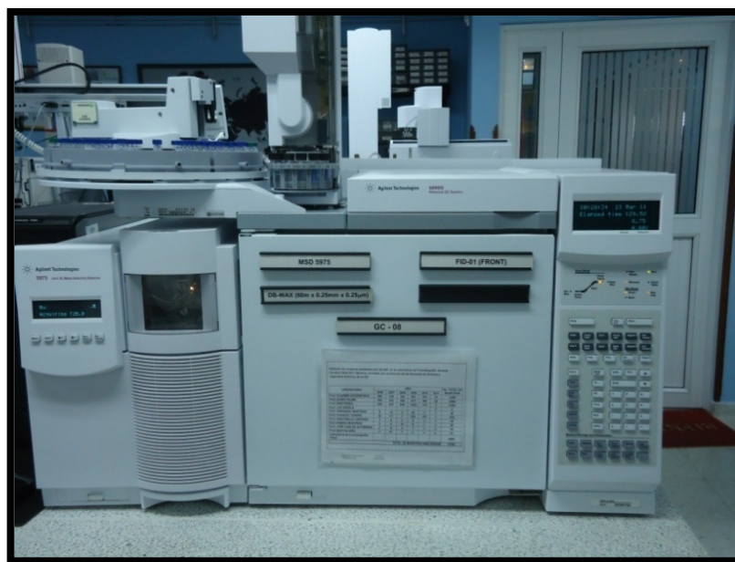
Figura 17. Cromatógrafo de gases Agilent Technologies 6890N Network Series GC , acoplado a un detector selectivo de masas Agilent Technologies 5975 Inert XL .
