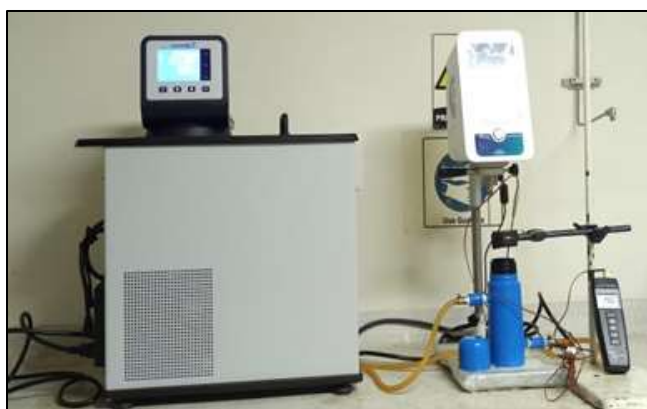
Figura 8. Montaje para la medición de la viscosidad de crudos.
