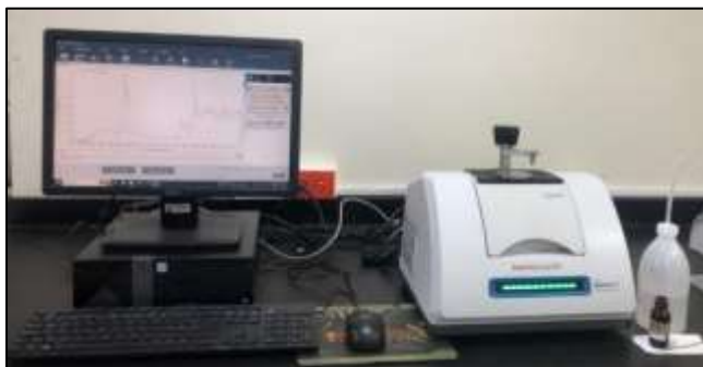
Figura 9. Espectrómetro de infrarrojo Nicolet™ Summit™ FTIR - ATR.
