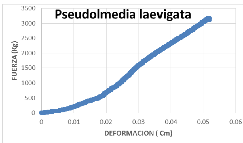
Figura 9. Comportamiento a cizallamiento Pseudolmedia laevigata
