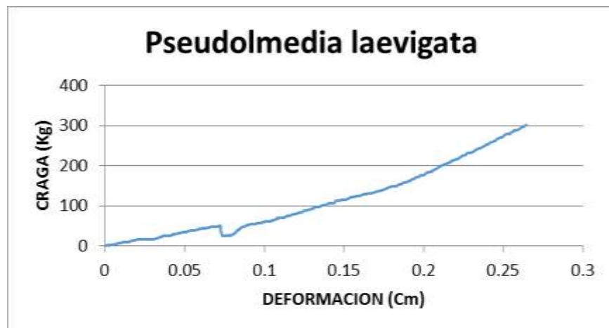
Figura 10. Comportamiento a Tensión paralela Pseudolmedia laevigata (leche perra)
