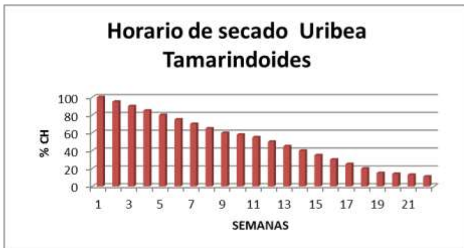
Figura 5. Estabilización contenido de humedad seco al aire. Tamarindo de monte
