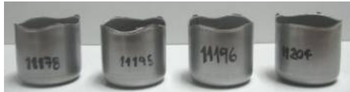
Figura 46. Copas embutidas usando SAE 1006 0.61 mm
