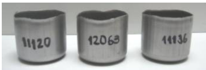
Figura 45. Copas embutidas usando SAE 1006 0.46 mm
