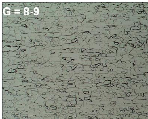
c). Lámina recocida . Ataque Nital al 2% .200X
