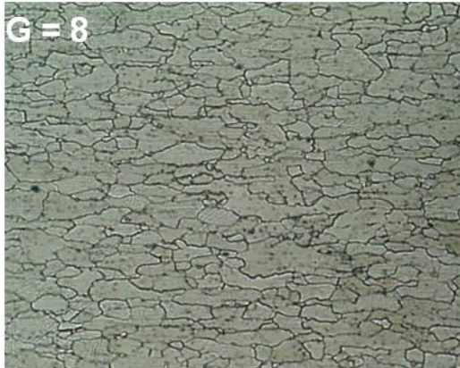
a). Bobina No. 11178. Ataque Nital 2%. 200X
