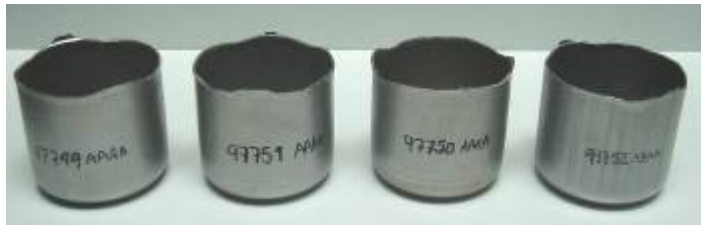
Figura 45. Copas embutidas usando SAE 1006 0.46 mm
