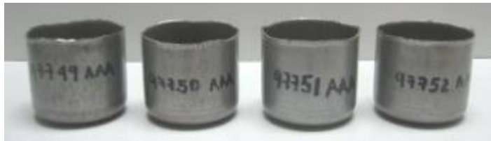
Figura 43. Copas embutidas usando acero IF 0.60 mm sin temple.
