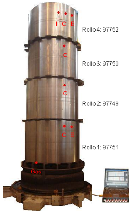
Figura 15. Esquema montaje experimental de la prueba de recocido.
