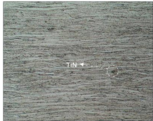
b). Laminado en frío 79.5 % reducción. Ataque Nital al 2% .200X
