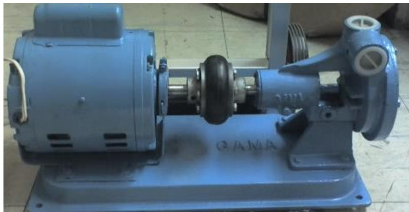
Figura 26. Motor instalado directamente en el eje de salida.
