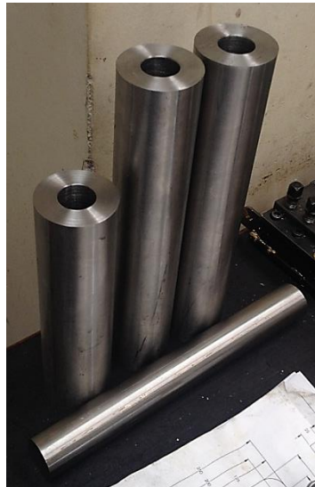
Figura 102. Acero inoxidable 304 con las perforaciones.
