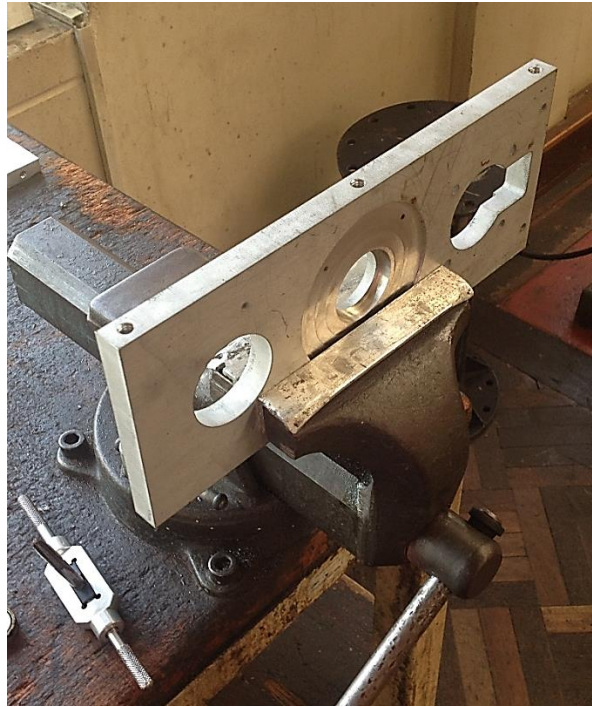
Figura 112. Proceso de roscado para lámina de 15 mm.
