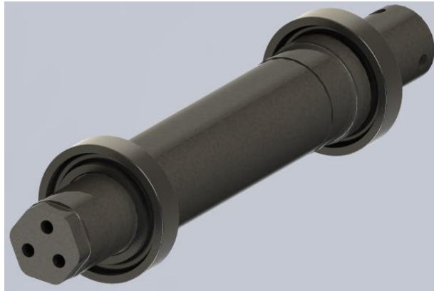
Figura 86. Ubicación de los rodamientos radiales en el eje Roll
