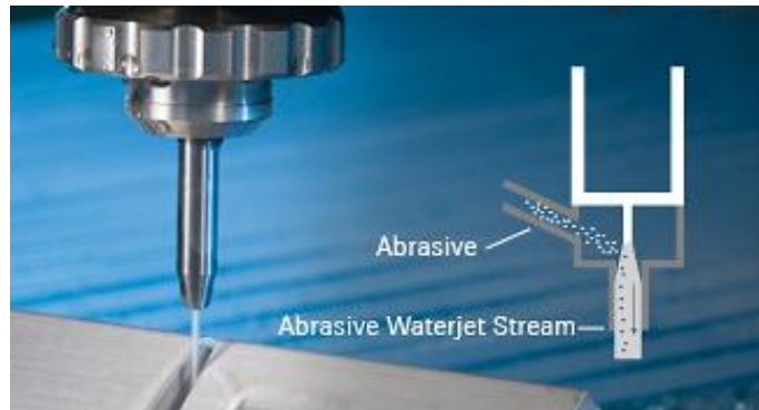
Figura 97. Proceso de corte por chorro de agua abrasivo.
