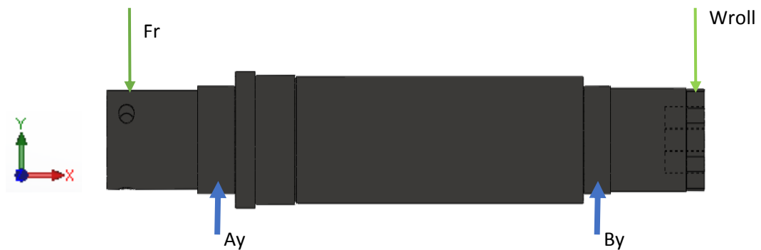
Figura 81. Diagrama de carga eje Roll. Plano X-Z
