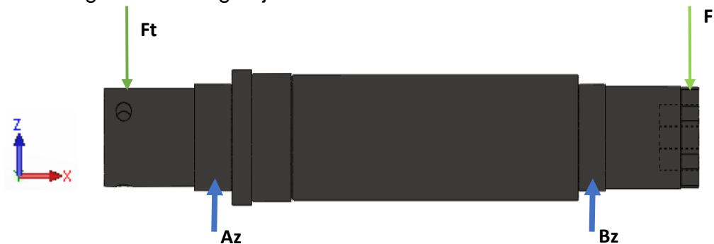
Figura 81. Diagrama de carga eje Roll. Plano X-Z
