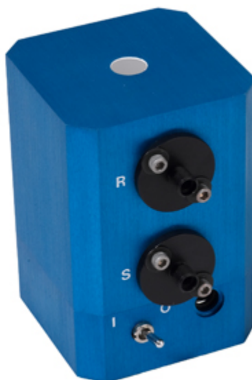
Figura A10 – 1 Esfera integradora ISP REF .
