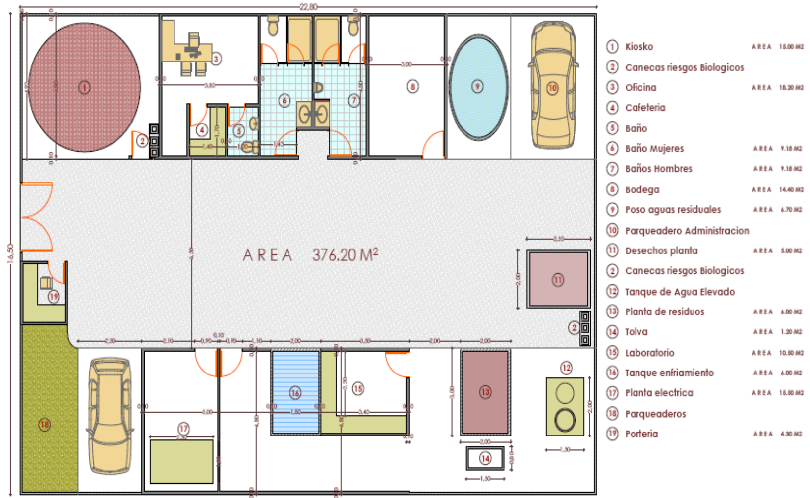
Figura 12. Distribución planta Centro de Acopio Los Colorados
