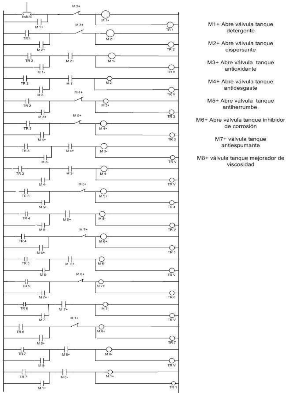
Figura N. 85 Lógica cableada para producir aceite para motor
