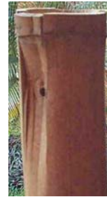
Foto 50 Aplastamiento EVP con nudo
