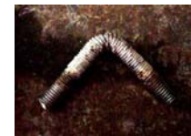
Foto 44 Falla perno transversal
