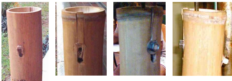
Foto 41 Falla por abolladura y cortante en dos planos EHP con nudo
