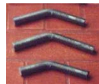
Foto 39 Deformación perno transversal
