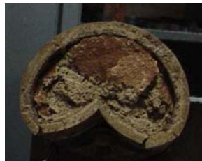
Foto 55 falla por aplastamiento para EVL
