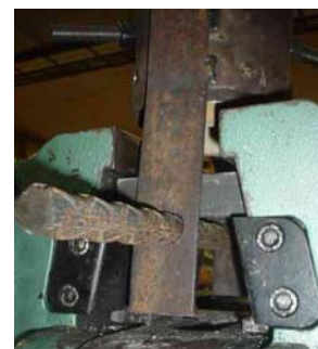
Foto 38 Sujeción del anillo de acero a la máquina
