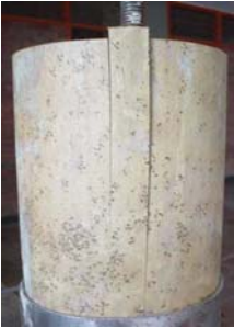
Foto 45 Falla por cortante EHL
