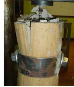
Foto 47 Falla por cortante múltiple
