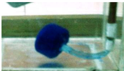
Figura 10. Fotografía del dispersor de aire
