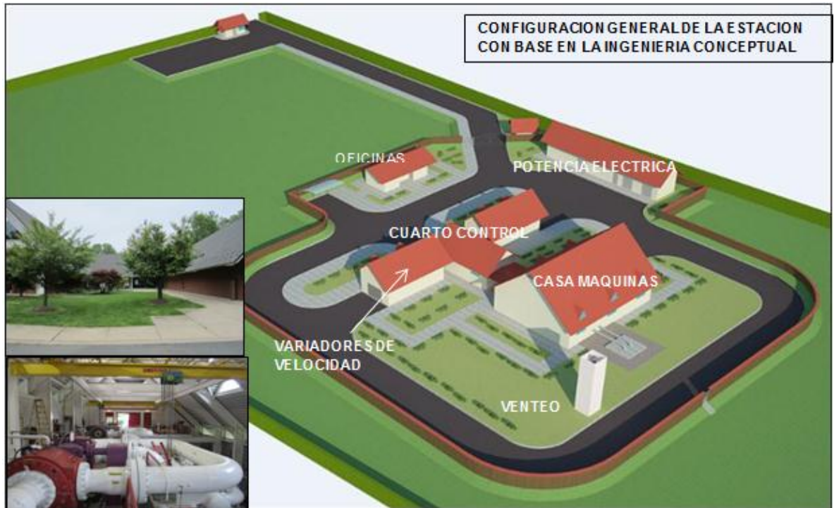
Ilustración 3. Estación de compresión con tecnología centrífuga
