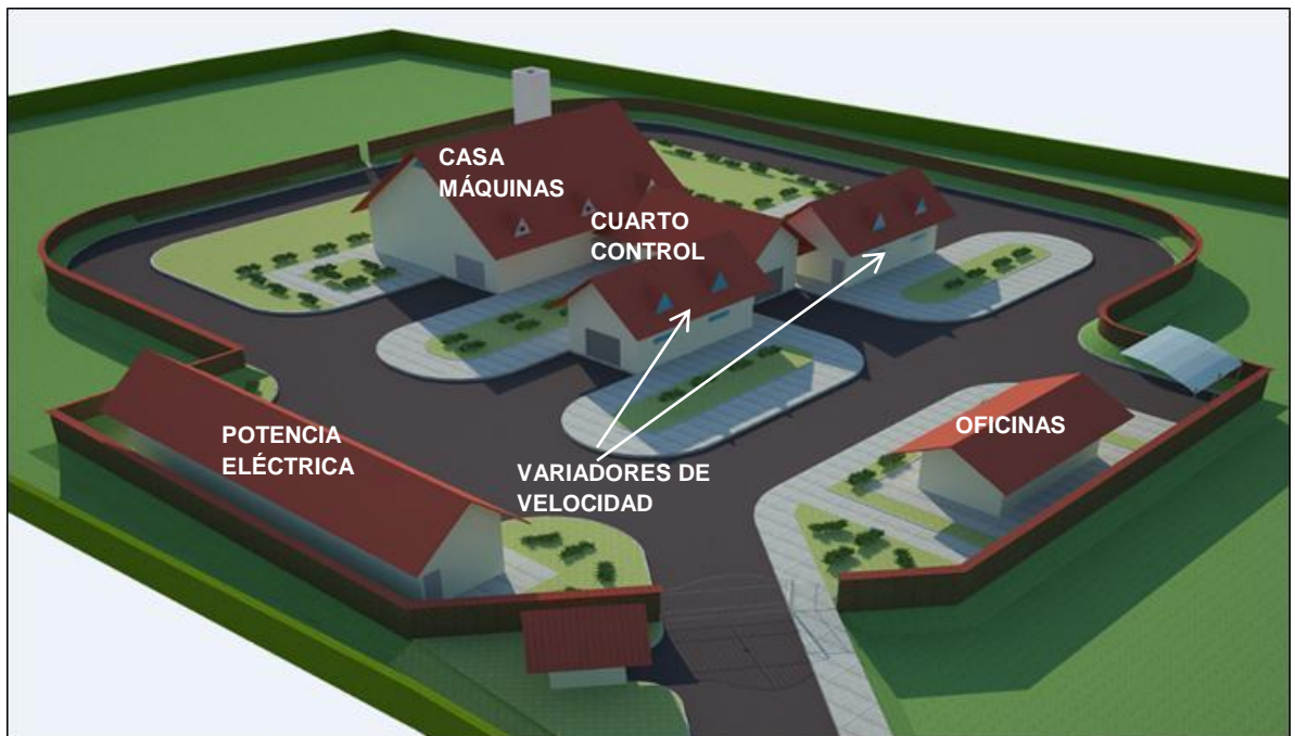
Ilustración 16. Diseños en 3D para la estación de compresión de La Sabana
