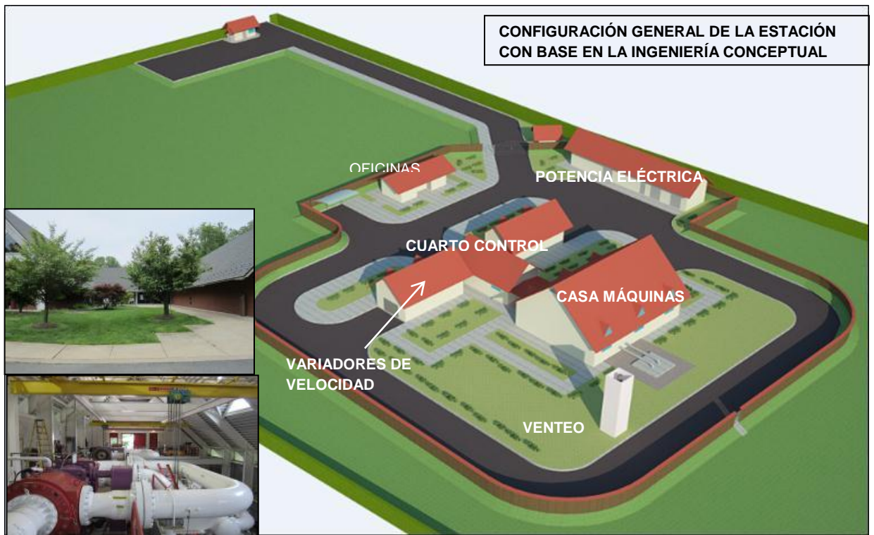
Ilustración 15. Diseños en 3D para la estación de compresión de La Sabana
