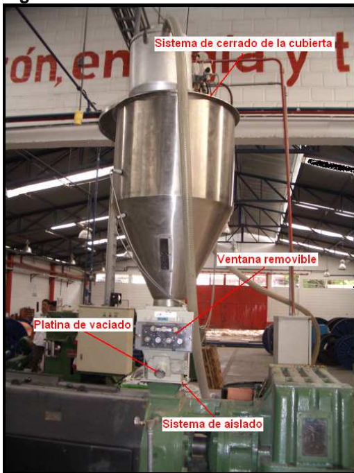
Figura 15. Tolva de alimentación de PVC/PE
