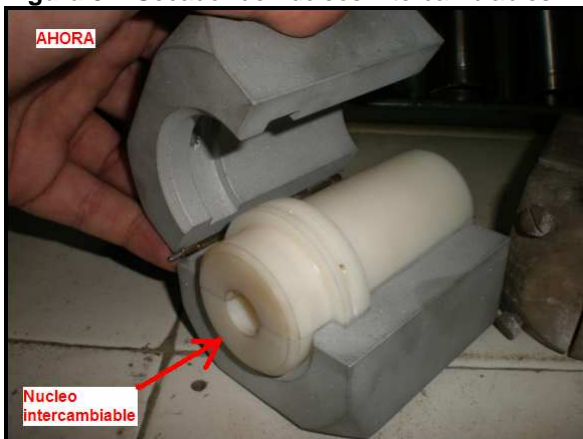
Figura 32. Secador de núcleos intercambiables
