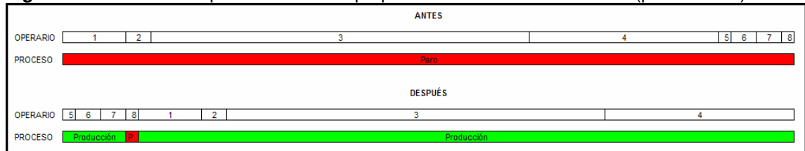
Figura 35. Cambio en el procedimiento de preparación extrusora de PVC/PE (porta mallas)
