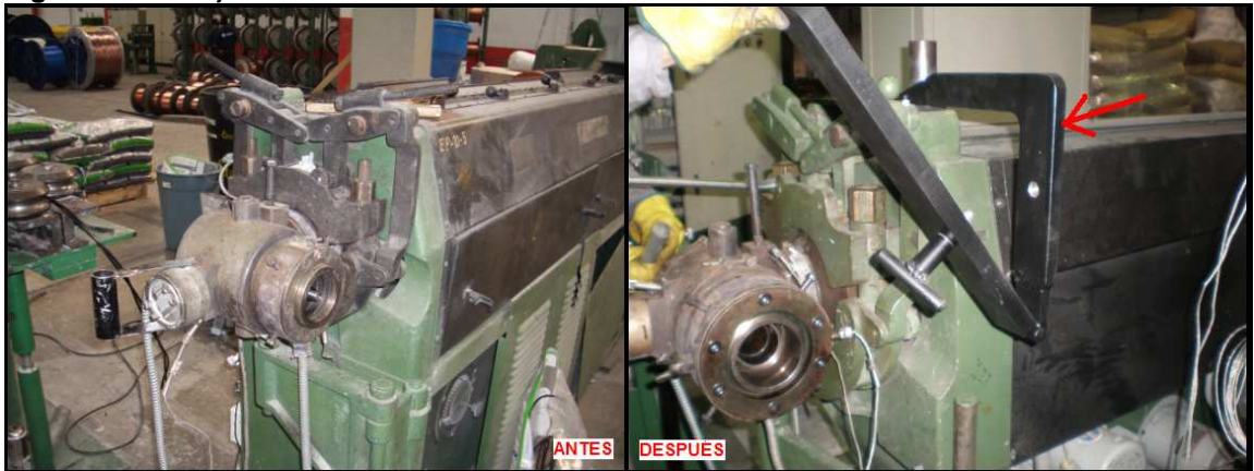
Figura 30. Anclaje externo del cabezal de PVC/PE.
