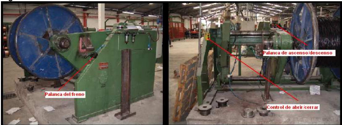
Figura 11. Devanador de la tercera línea de extrusión
