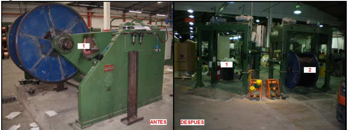
Figura 29. Sistema alterno de dos devanadores.
