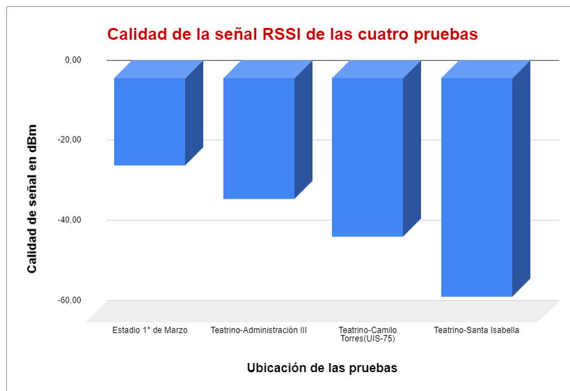
Figura 4.24: Calidad de la señal RSSI en decibelios para las pruebas de comunicación
