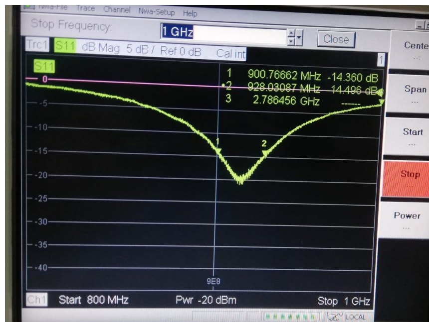
Figura 8.1: Espectro de coeficiente de reflexión antenna monopolar
