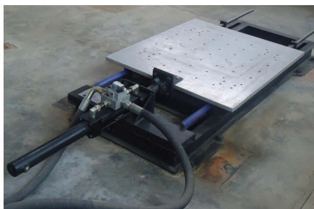
Figura 1. Mesa sísmica del grupo de investigación DICBoT - UIS.
