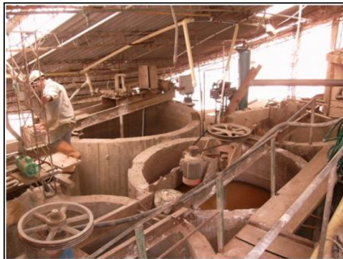
Figura 9. Piscinas de soluciones cianuradas en la separación química de sulfuros
