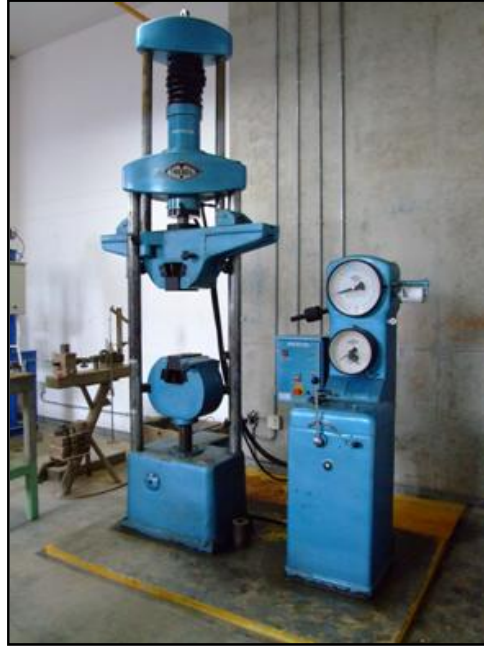
Figura 33. Máquina de ensayos universal tipo Shenck Trebel.
