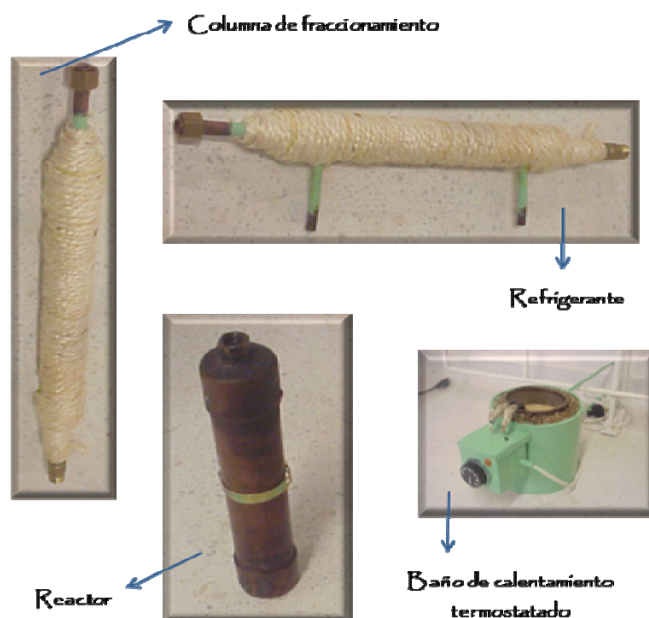
Fotografía 6. Equipo de destilación fraccionada en cobre.
