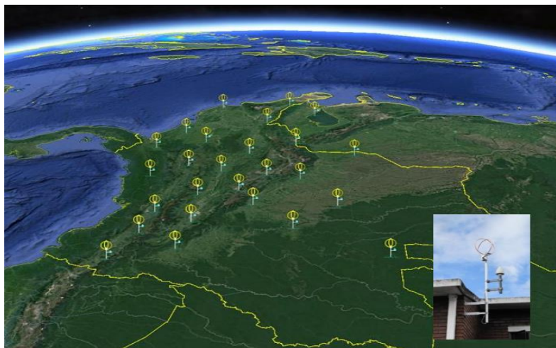
Figura 4. Sensores de la red de localización de rayos LINET
