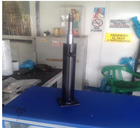
Figura 51. Cilindro hidráulico terminado.
