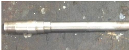
Figura 54. Eje después de la operación de torneado.
