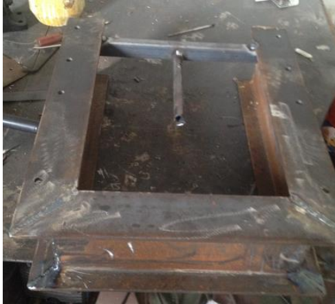
Figura 48. Armado de la base del emulador hidráulico.
