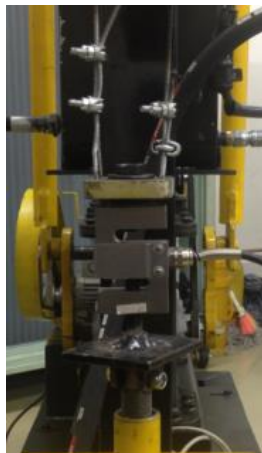
Figura 70. Montaje de la celda de carga al banco.
