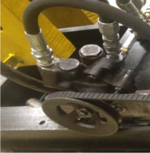
Figura 34. Bomba acoplada al banco prototipo.
