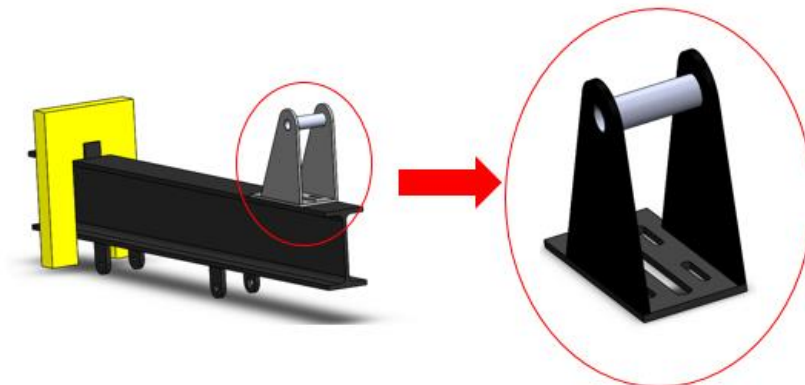
Figura 11. Dispositivo de ensamble del cabezal con la viga viajera.
