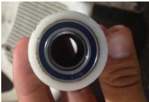
Figura 57. Rodamiento ensamblado en la carcasa.
