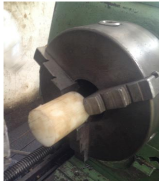
Figura 56. Duralon montado en el torno.
