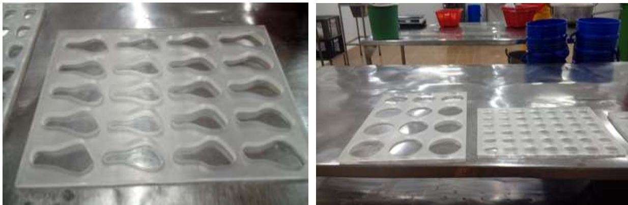
Figura 33. Nuevas plantillas en acrílico.
