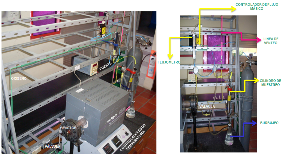
Figura 4. Montaje realizado para la gasificación de asfaltenos en el laboratorio de corrosión de alta temperatura ICP
