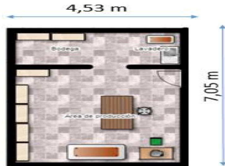
Figura 13. Distribución de planta operativa
