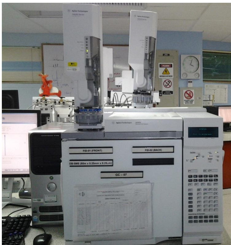
Figura 13. Cromatógrafo de gases AT 6890N (Agilent, Palo Alto, California, EE. UU.) acoplado a un FID. Foto: Liliana Bernal. Centro de Investigación de Excelencia, CENIVAM. Universidad Industrial de Santander, Bucaramanga, 6 de julio de 2017.
