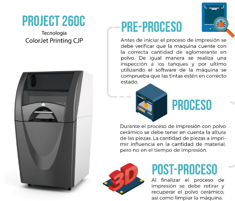
Figura 27. Procedimiento para tecnología CJP
