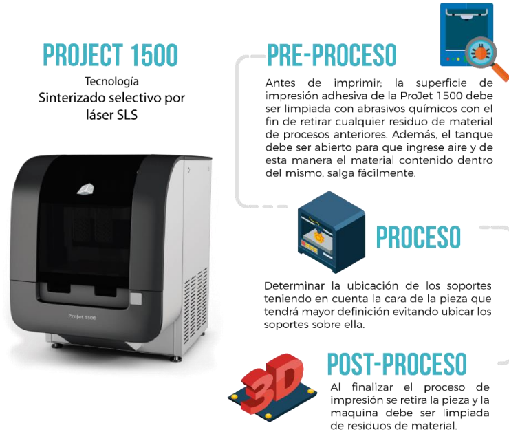
Figura 27. Procedimiento para tecnología CJP
