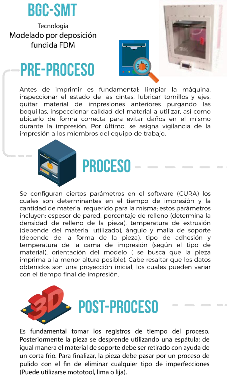
Figura 28. Procedimiento para tecnología FDM
