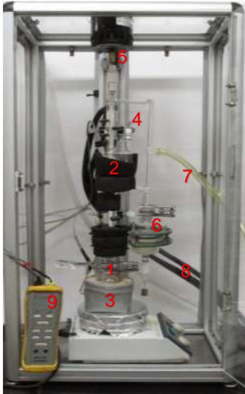
Figura 4. Equipo de destilación fraccionada B/R instrument 800- High Efficiency Micro Distillation
