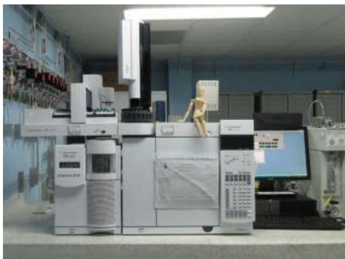
Figura E1. Cromatógrafo de gases de alta resolución Agilent Technologies 7890 A , acoplados a espectrómetros de masas Agilent Technologies 5975C ,
