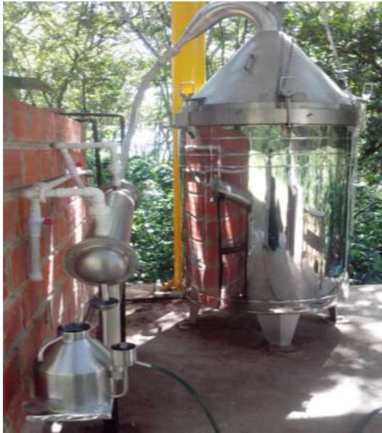
Figura 3. Equipo de destilación por arrastre con vapor
