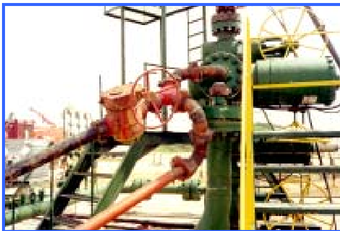
Figura 22. Conexión a Cabeza de Pozo.
