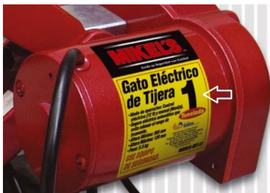
Figura 5. Carga máxima de un elevador dada por el fabricante (1 TON).
