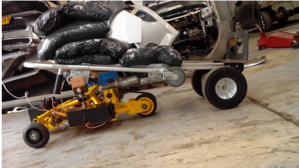
Figura 72. Prueba de capacidad en pendiente de 15%.
