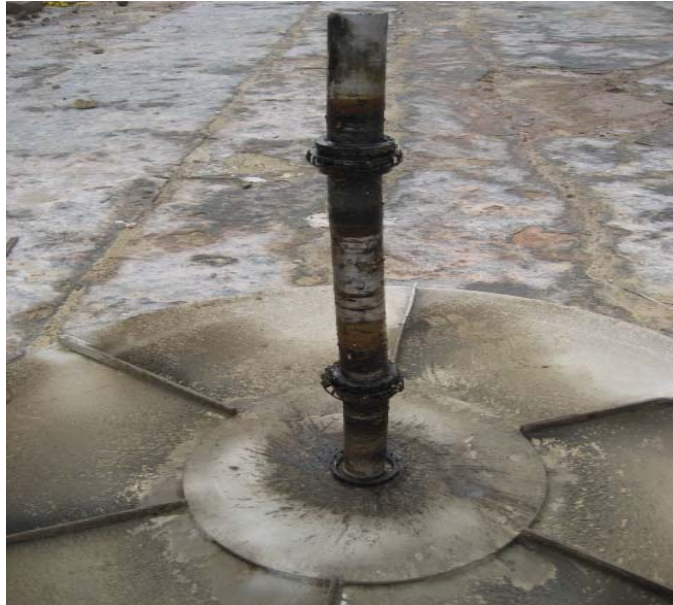
Ilustración 32, Deformación causada en el eje del impulsor por encostramiento
