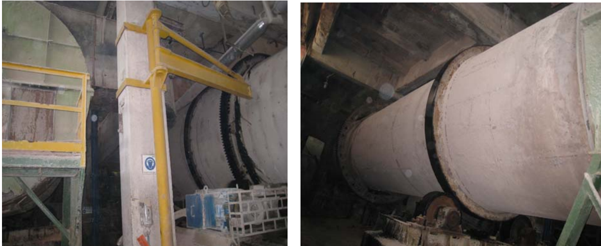
Ilustración 30, Sistema motriz y llantas del tambor Granulador
