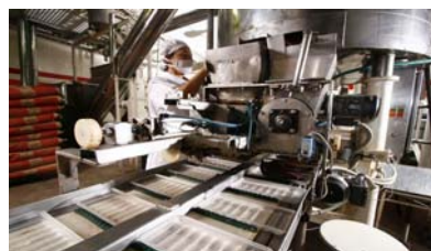
Figura 8. Proceso de dosificado
