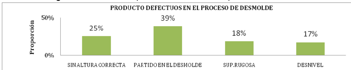
Figura 35. Producto en proceso defectuoso en el proceso de desmolde.
