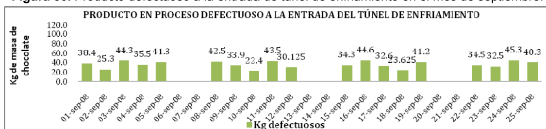
Figura 50. Producto defectuoso a la entrada de túnel de enfriamiento en el mes de septiembre.
