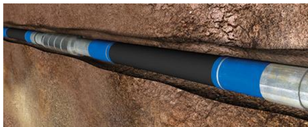
Figura 20. Completamiento con aislante parcial del liner
