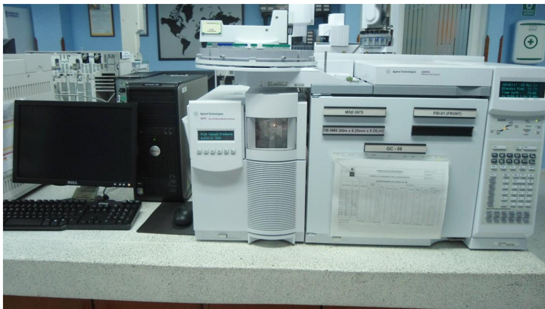
Figura 12. Cromatógrafo de gases Agilent Technologies 6890 Plus (Palo Alto, CA, EE.UU.) acoplado a un detector selectivo de masas Agilent Technologies MSD 5973 Network. Centro de Cromatografía y Espectrometría de Masas Mikhail Tswet, CROM-MASS, CENIVAM. Foto: María E. García, julio de 2012.
