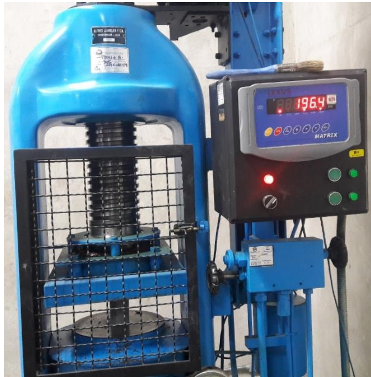
Figura 3 Maquina para la elaboración de ensayos de compresión simple
