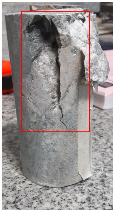
Figura 45 Ensayo de Compresión simple al Neis Cuarzo Feldespático
