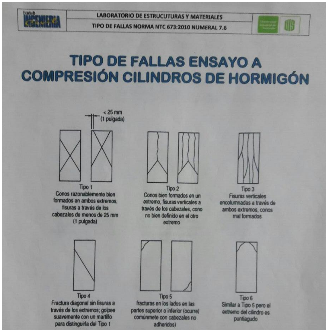
Figura 4 Tipo de fallas ensayo Compresión simple.
