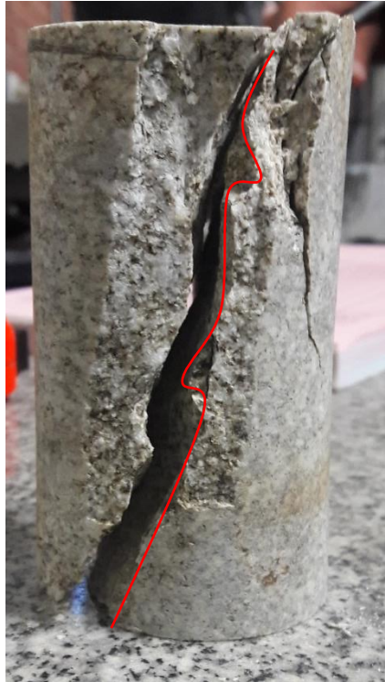
Figura 47 Ensayo de Compresión simple al Neis Moscovítico.
