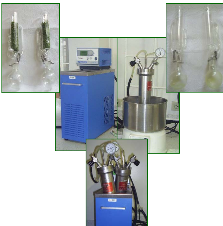
Figura 25. Equipo Soxhlet de alta presión (J & W Scientific ) para la SFE con CO 2 .
