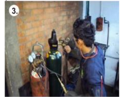
3. Accione (profundice) el tornillo de regulación de oxígeno, verifique y ajuste la presión de trabajo requerida.
