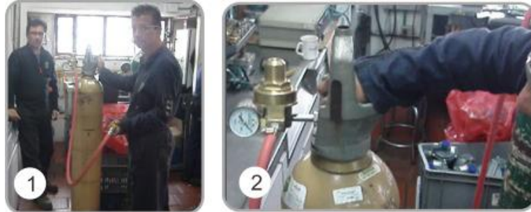
Figura 48. Verificación de fuga
