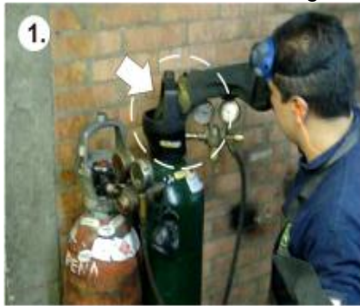
1. Abra la válvula del cilindro de acetileno
