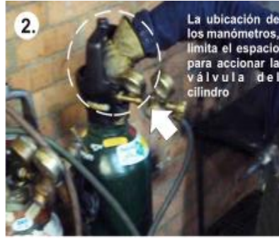
2. Abra la válvula del cilindro de oxígeno
