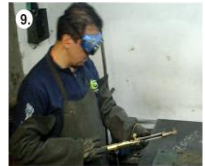
9. Al terminar el corte, cierre las válvulas del soplete, repita los pasos 4,3,2 y 1 sacando el tornillo del regulador y cerrando la válvula del cilindro.
