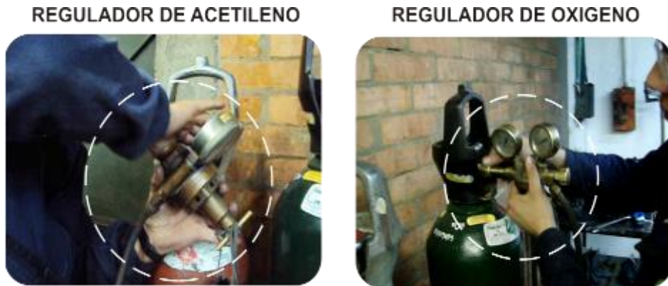
Figura 21. Modo de sujetar los reguladores
