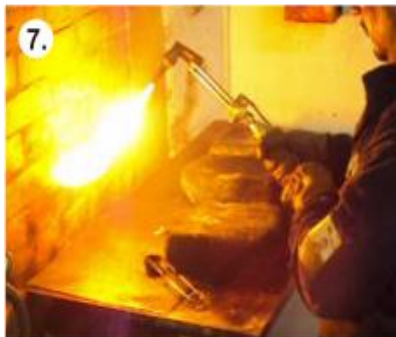
7. Regule la fuerza de la llama, permita el paso de acetileno con la válvula del soplete.
